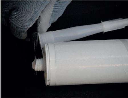
Kartusche mit einem Cutter aufschneiden.
